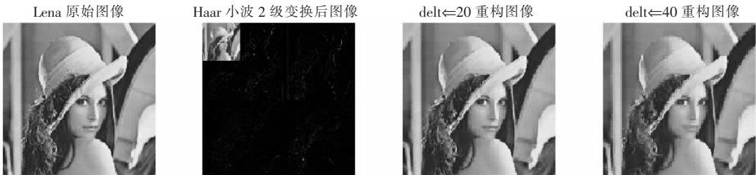
图 6 整数 Haar 小波变换图像压缩和解压效果 Fig. 6 Image compression and decompression effect of integer Haar wavelet transform
